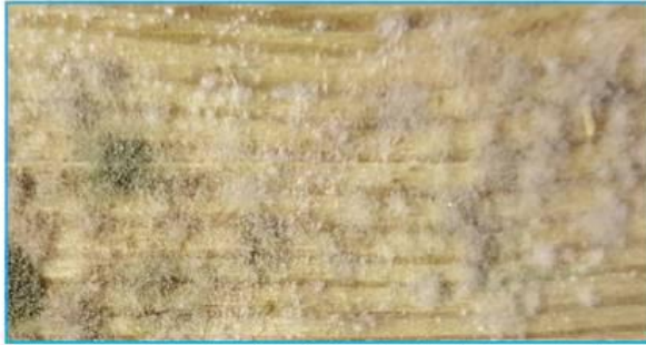
Oppervlakte schimmel: verdwijnt kort na plaatsting in de buitenlucht. met een borstel en water ook direct te verwijderen
